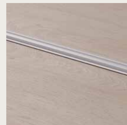
PROFIL WIELOFUNKCYJNY, SREBRNY 1860 × 47 × 16 mm Profil dylatacyjny i wyrównujący w jednym. Odpowiedni do różnic wysokości wynoszących od 0 do 12,3 mm. Wysokość: 10 mm (przed montażem) Aluminium. PGPRSILV
